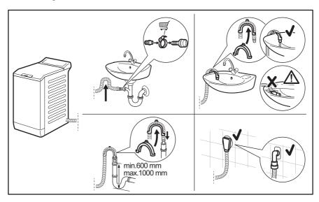
Le tuyau de vidange doit être installé à une hauteur du sol comprise entre 600 et 1 000 mm. La longueur maximale du tuyau de vidange est de 4000 mm. Contactez le service aprèsvente agréé pour obtenir d'autres longueurs de tuyaux de vidange et des rallonges.
