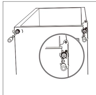
**Mise en garde!** S'il y a une vis dans le coin avant gauche, retirez-la avant d'installer la charnière.
