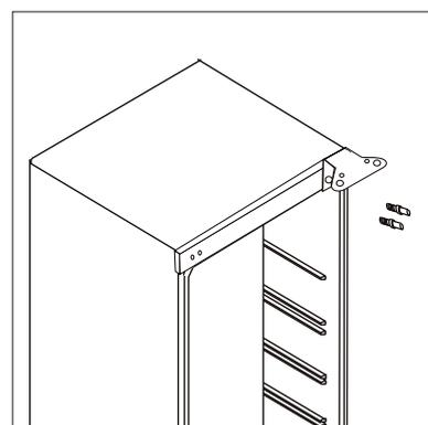
3. Retirez le couvercle et les vis du côté gauche puis du côté droit.
