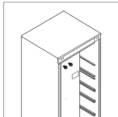
4. Allongez soigneusement l'arrière de l'armoire sur un coussin souple. Supprimer deux frais de nivellement level trst. Dévissez ensuite la charnière de la porte et la base du pied gauche.
