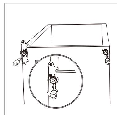
6. Installez la charnière sur le côté gauche et la base du pied sur le côté droit. Vissez ensuite deux pieds de mise à niveau avec leurs pièces d'origine.
